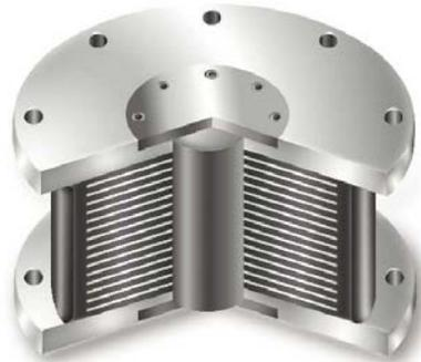
**Figura 3.9:** Aislador de capas de goma y acero y núcleo de plomo.<sup>24</sup>
