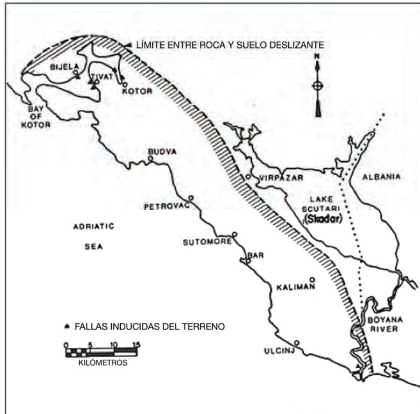
Figura I 15-3: La autopista del Adriático quedó en la zona que los trabajos de campo hechos en Montenegro, identificaron como zonas de terrenos inestables. (Fuente: Leeds, 1980, editor, EERI, 1980, p. 64)
