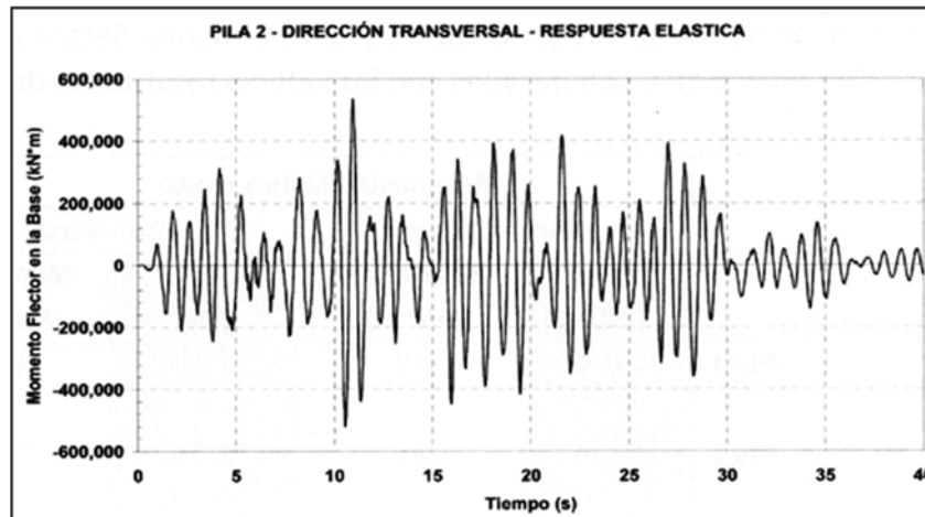
Figura I 39-4: Historia de los momentos flectores en la base, dirección transversal en la Pila 2, que alcanzan 550 mil kN-m asumiendo respuesta elástica. (Fuente: Hernández et al., 2001)
