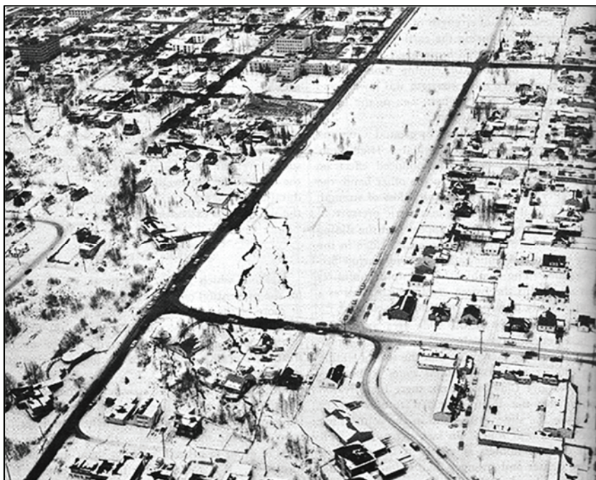
Figura I 6-2: Formación de un graben al sur de la calle L. (Fuente: Wood, 1967, p. 276)
