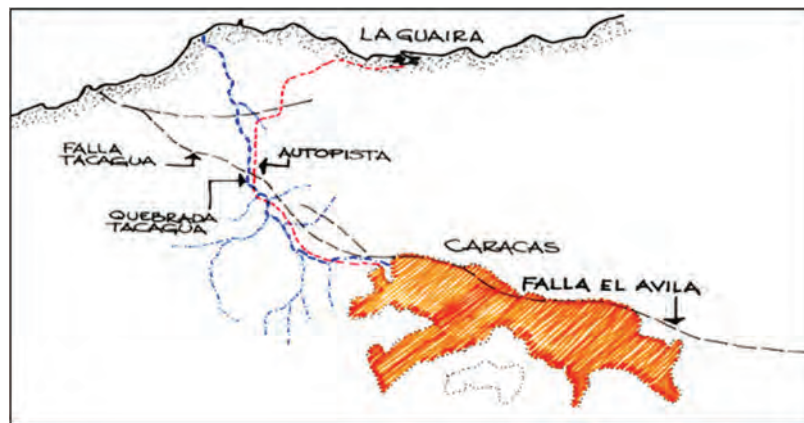
Figura I 40-1: Descripción simplificada de la ubicación del valle de Caracas respecto al Litoral Central, la tectónica de la región y la autopista planificada. No se indica la ubicación del aeropuerto de Maiquetía pocos kilómetros al oeste de La Guaira. (Fuente: Acosta, 1999)
