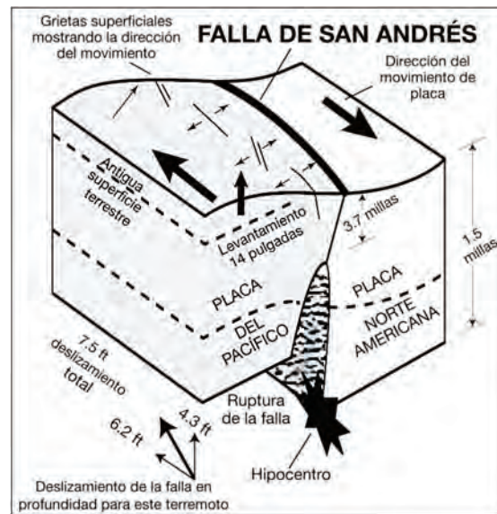
Figura I 24-2: Diagrama esquemático del mecanismo en la falla de San Andreas. Observe que la profundidad focal es de 11.5 millas y el desplazamiento superficial puede tardar horas en ser visible. (Fuente: U.S. Geological Survey Department of the Interior/USGS U.S. Geological Survey)
