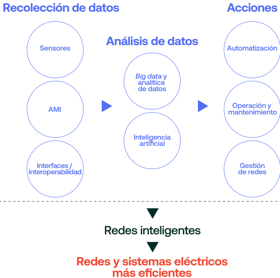
Figura 3.8 — Componentes para la mejora del diseño y la planeación de las redes eléctricas mediante la digitalización y el desarrollo de redes inteligentes
