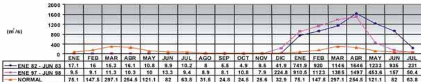
Figura II.1-3 Perú. Descarga promedio mensual del Río Chira (Piura) durante 1982-83 y 1997-98 (m 3 /s)
